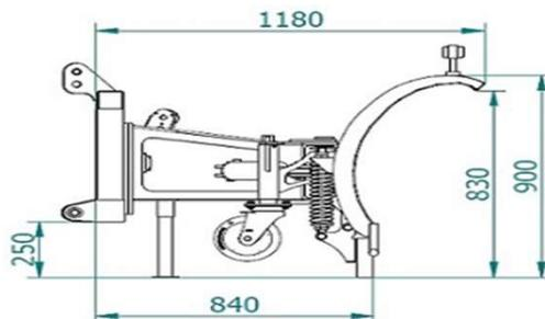
Hydraulisch schwenkbar links/rechts 30°
