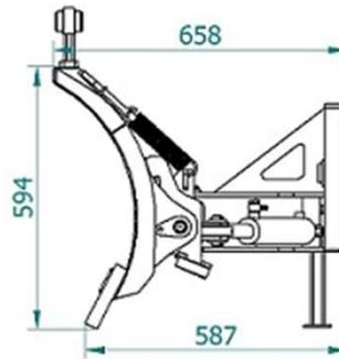
Hydraulisch schwenkbar links/rechts 25°
