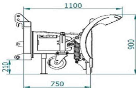
Hydraulisch schwenkbar links/rechts 30°
