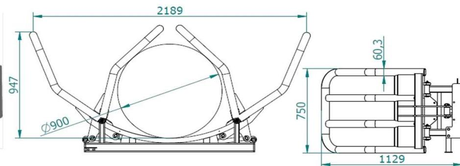
Rohr  $\varnothing$  60 x 3 mm
