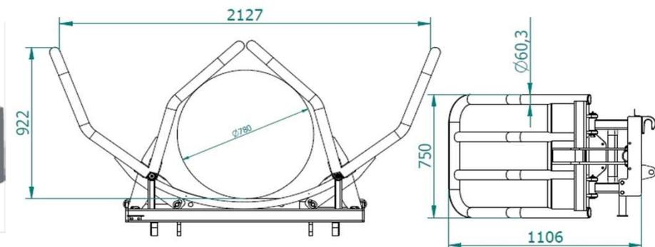
Rohr  $\varnothing$  60 x 3 mm
