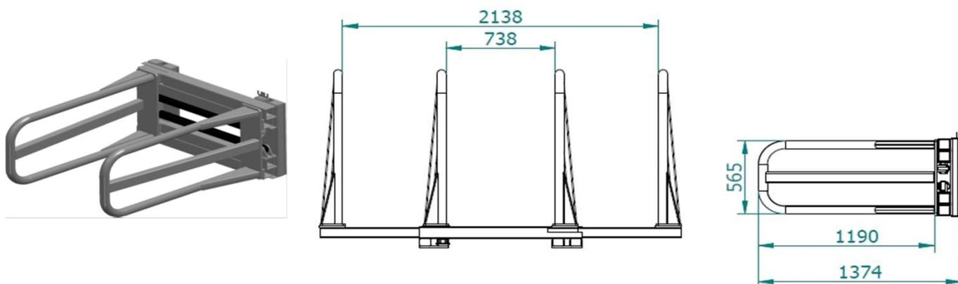
Rohr  $\varnothing$  60 x 3 mm
